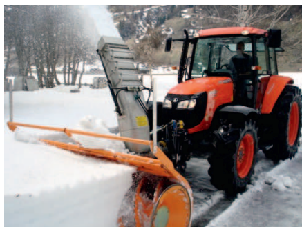
Kubota M108S mit Frontschneefräse im Einsatz
